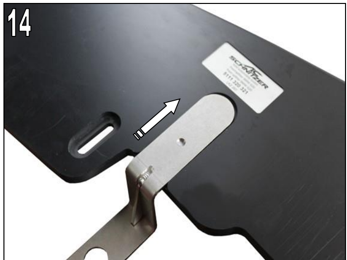
Abb. 14 AC Schnitzer Befestigungshalter in AC Schnitzer Frontsplitter, wie abgebildet, einlegen.
