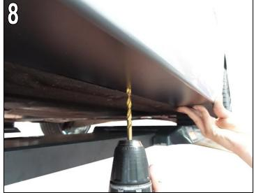
Spreiznieten vorn und hinten wieder entfernen und AC Schnitzer Seitenschweller abnehmen.
