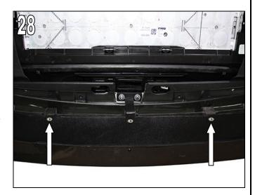
Unterbodenverkleidung wieder montieren.
