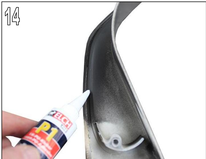
Klebefläche am Heckschürzeneinsatz mit dem mitgelieferten Reiniger reinigen.
