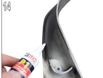
Klebefläche am Heckschürzeneinsatz mit dem mitgelieferten Reiniger reinigen.
