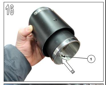
**Fig. 17**Push AC Schnitzer tailpipe trims onto the AC Schnitzer silencer.
