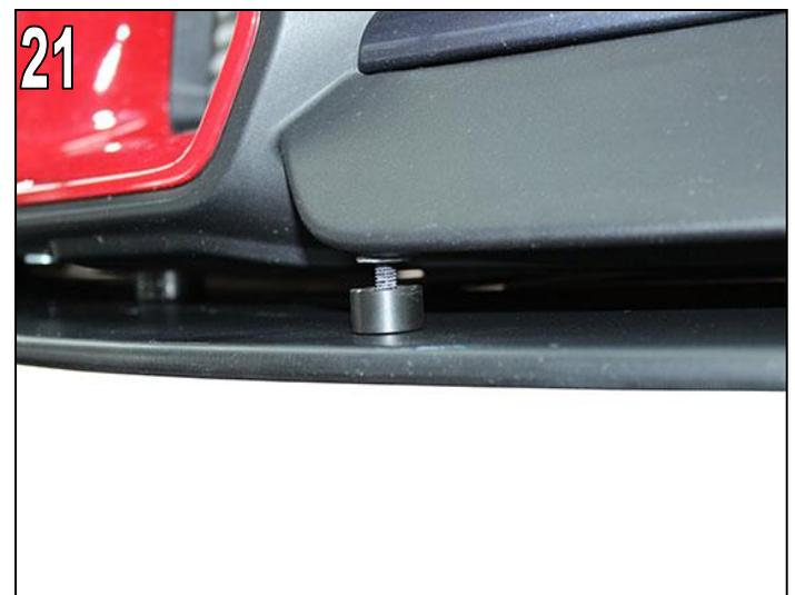
AC Schnitzer Distanzhülse mit der Aussparung für den Hohlraumanker nach **oben** montieren / einsetzen.
