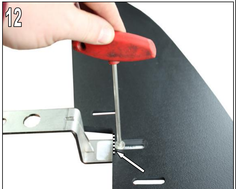
Abb. 12 AC Schnitzer Befestigungshalter mit der mitgelieferten Senkkopfschraube M6x10mm am AC Schnitzer Frontsplitter montieren und festziehen.
