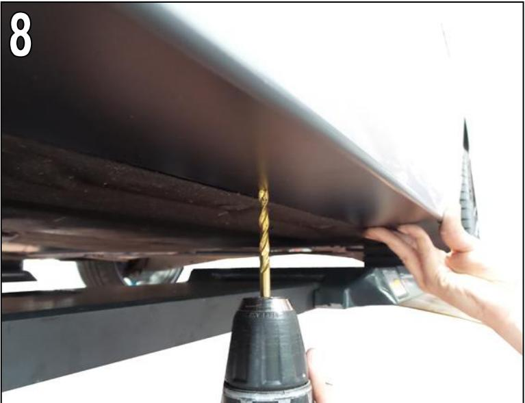
Spreiznieten vorn und hinten wieder entfernen und AC Schnitzer Seitenschweller abnehmen.
