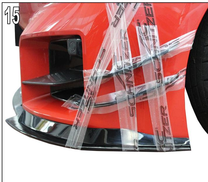
Auf parallelen Verlauf der AC Schnitzer Front side Wings achten. Ggf. AC Schnitzer Front Side Wing parallel zum unteren AC Schnitzer Front Side Wing ausrichten.
