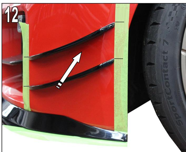
AC Schnitzer Front Side Wing mit Klebeband fixieren.
