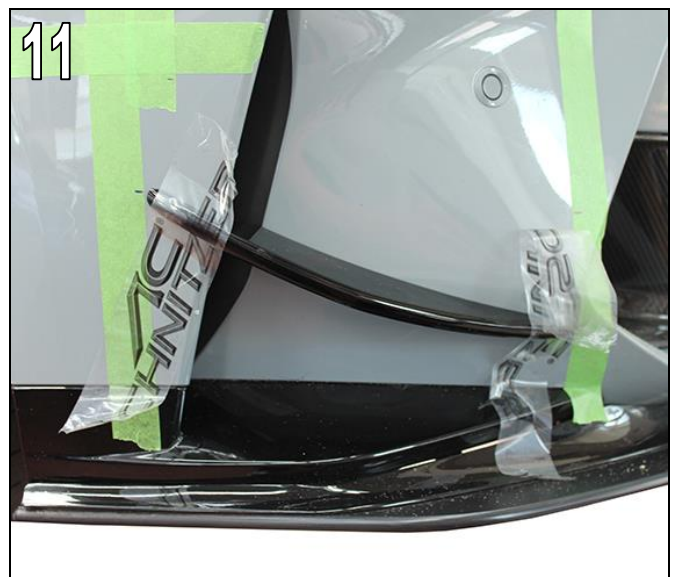
Abb. 11 AC Schnitzer Front Side Wing mit Klebeband fixieren.
