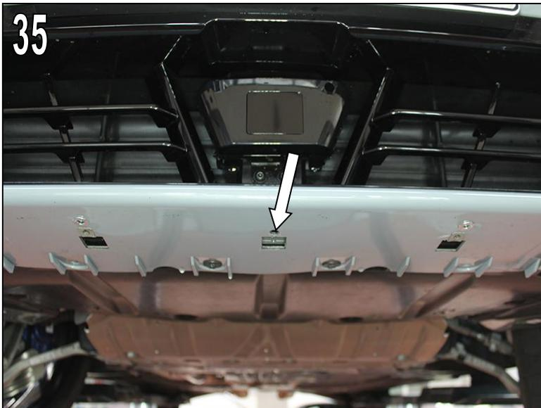
AC Schnitzer Frontsplitter nach Abbildung 14 bis 18 wieder montieren.
