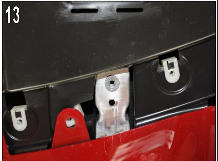
AC Schnitzer Frontsplitter nach Arbeitsschritt **Abb. 7 bis Abb. 9** wider montieren und ausrichten.
