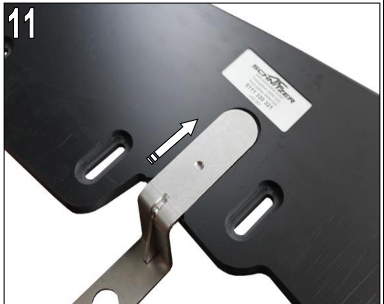
Abb. 11 AC Schnitzer Befestigungshalter in AC Schnitzer Frontsplitter, wie abgebildet, einlegen.
