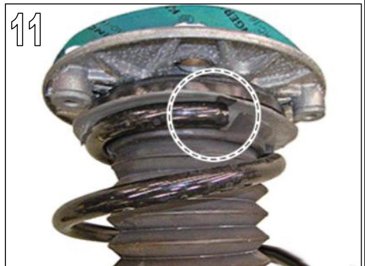
Mutter ersetzen und mit Spezialwerkzeug 33 0 040 festziehen. Anzugsdrehmoment beachten !
