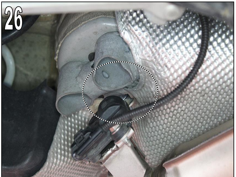
Abb. 26 M4 Cabrio (G83) Ggf.: Für ausreichend Freigängigkeit vom Abgasklappenmotor zur Torsionsstrebe sorgen.
