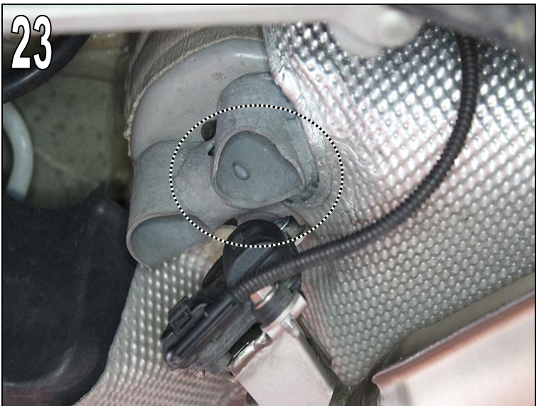
Abb. 23 M4 Cabrio (G83) Ggf.: Für ausreichend Freigängigkeit vom Abgasklappenmotor zur Torsionsstrebe sorgen.
