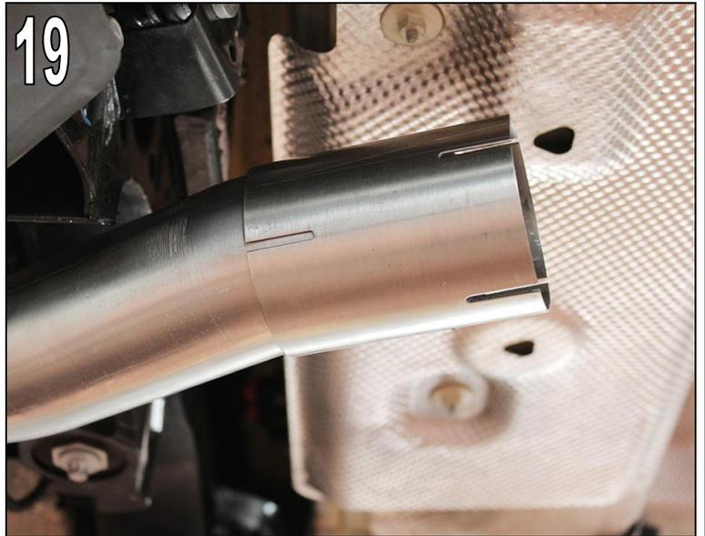
Klemmschelle des AC Schnitzer Schalldämpfers leicht anziehen.
