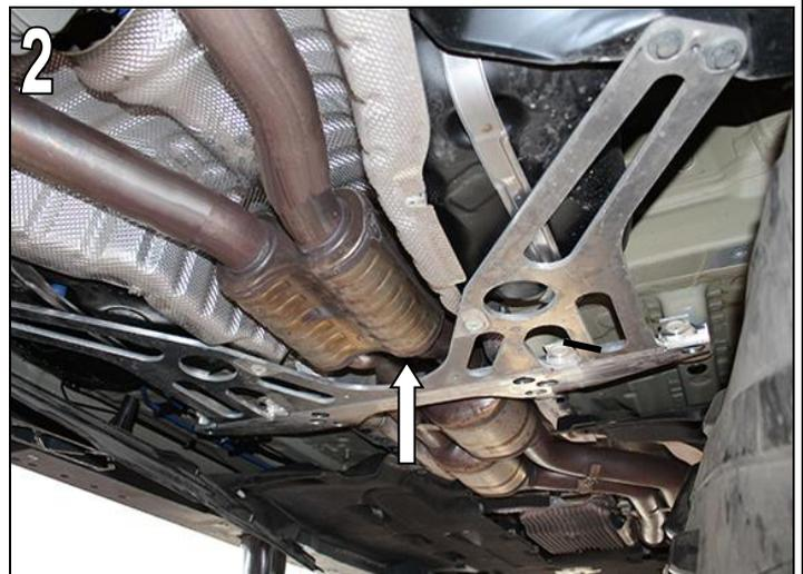
Serienschalldämpfer mit geeignetem Hilfsmittel abstützen.
