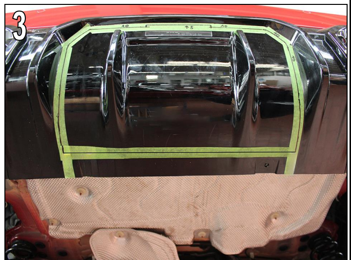
Abb. 2 & 3 Heckschürzeneinsatz mit Abdeckband an der inneren Kontur, wie abgebildet, abkleben.
