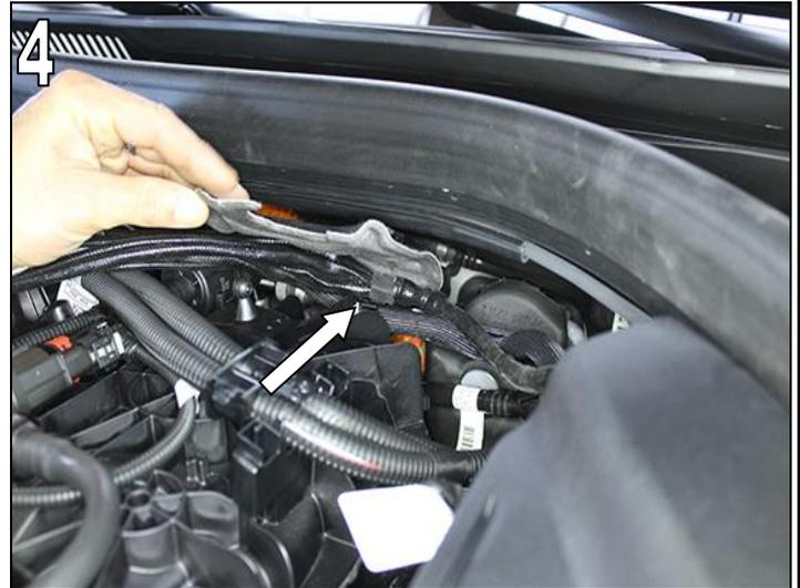
Die Zuordnung der benötigten Signale ist am AC Schnitzer Kabelbaum entsprechend gekennzeichnet. Alle relevanten Signale werden an den jeweiligen Sensoren / Aktoren „geschliffen“.
