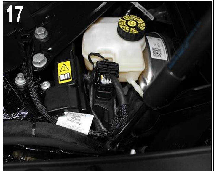
+12 Volt Stromversorgung des Motors wieder herstellen, dazu die Kabellleitung am +12 Volt Zentralpunkt wieder montieren.
